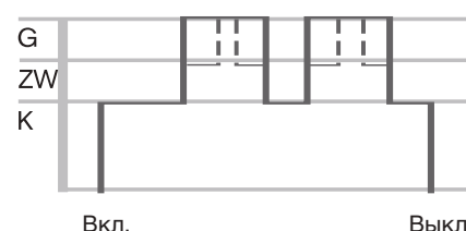
Трёхступенчатое регулирование (жидкотопливная часть)
