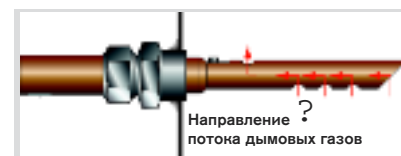
Устройство для забора пробы дымовых газов
