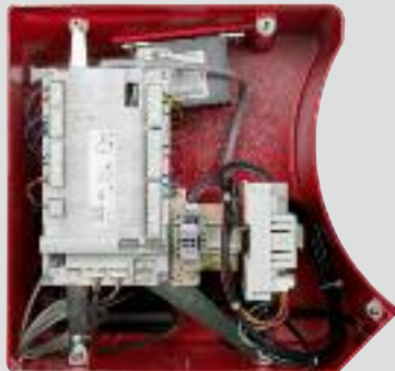
Менеджер горения W-FM54 в корпусе горелки
